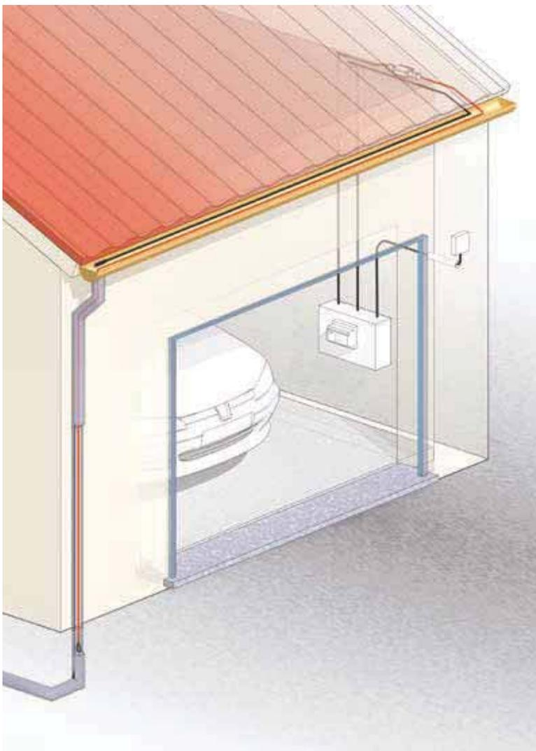
Im Fallrohr: Heizband bis zum frostfreien Bereich verlegen
