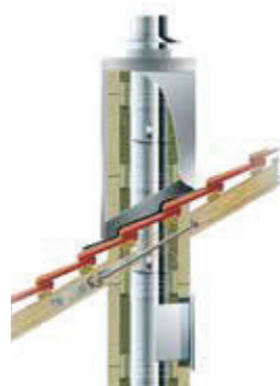
Beispiel: Stülpkopf Alu als Verkleidung über Dach.
