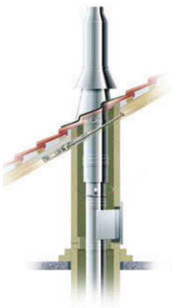
Beispiel: doppelwandiges Edelstahlelement als Verkleidung über Dach.
