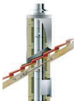
Beispiel: Stülpkopf Alu als Verkleidung über Dach.
