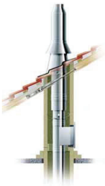
Beispiel: doppelwandiges Edelstahlelement als Verkleidung über Dach.
