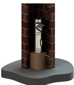
5.) Kondensatschale mit den vormontierten Formteilen auf den festen Schachtboden stellen
